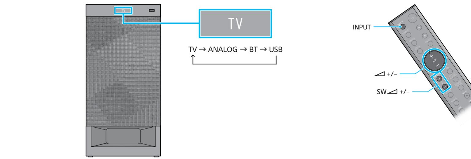
Pulse INPUT varias veces hasta que el dispositivo que deseé aparezca en visor del panel frontal. A continuación, pulse varias veces para ajustar el volumen del sistema y pulse SW varias veces para ajustar el volumen del Altavoz de graves.
