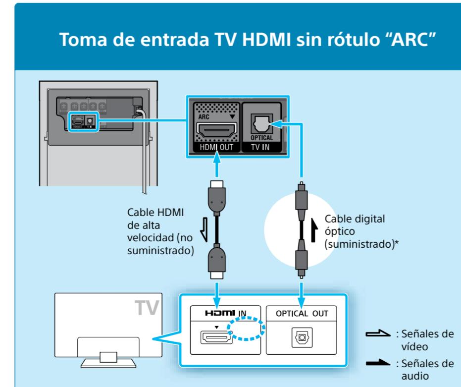
\* Si su TV no es compatible con la función ARC (Audio Return Channel), conecte un cable digital óptico (suministrado) para escuchar el sonido del televisor.
