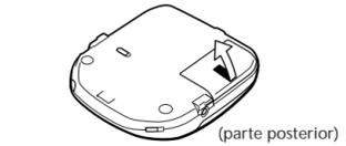
**2** Inserte la pila recargable de forma que la palabra “SONY” quede en la misma dirección que muestra la ilustración dentro de la tapa, y cierre ésta.
