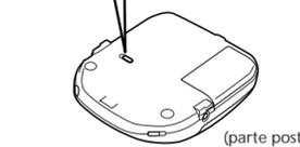
Ajuste AVLS en LIMIT. Aparece la indicación AVLS.
